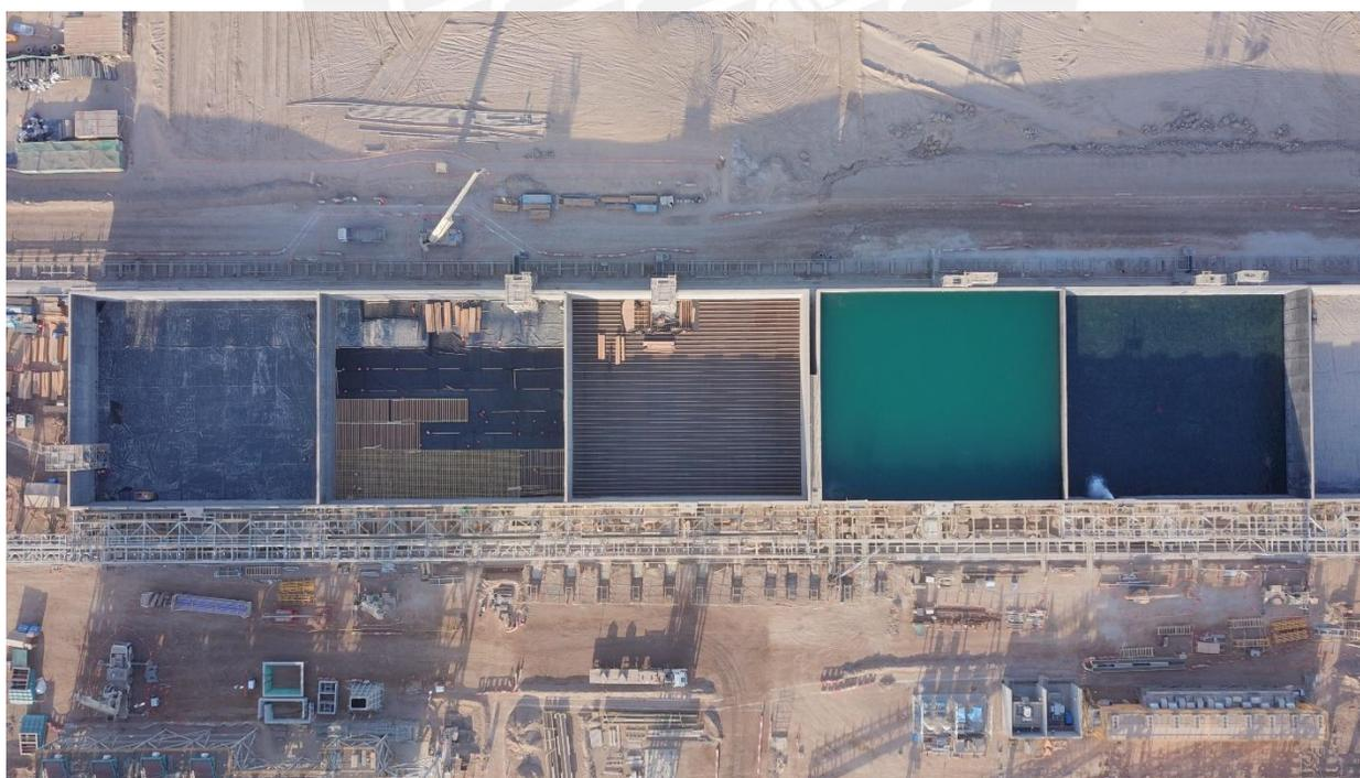
**Figura 4.4.14 Liner, prueba hidrostática y colocación de madera en piso**
