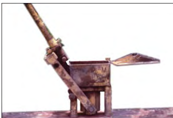
Figura 2.9: Primer modelo de prensa, CINVA Ram (AVEI (Auroville Earth Institute), 2015)
