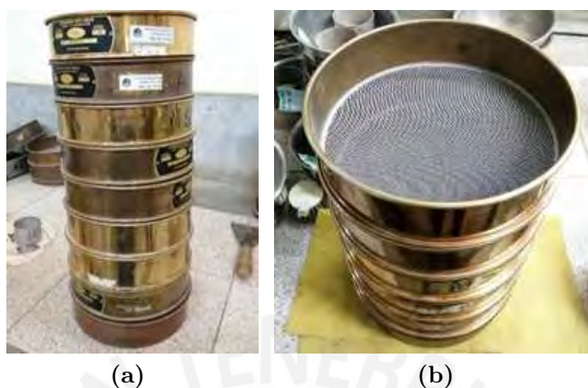
Figura 4.4: Juego de mallas para tamizar el material (a) retenido y el (b) que pasa por la malla #10.
