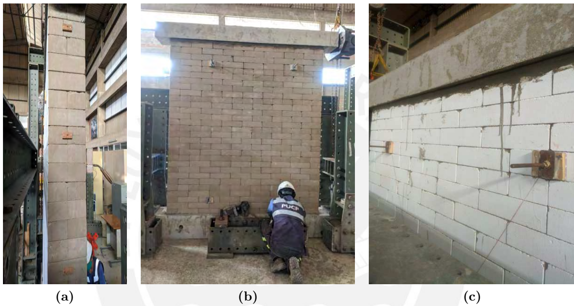
Figura 5.23: Instrumentación y colocación de los LVDTs en los muros.
