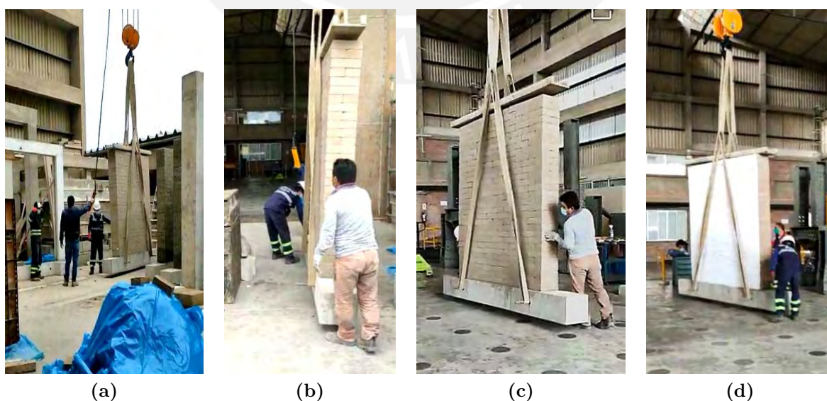
Figura 5.22: Izaje y traslado de los muros al área de ensayo.
