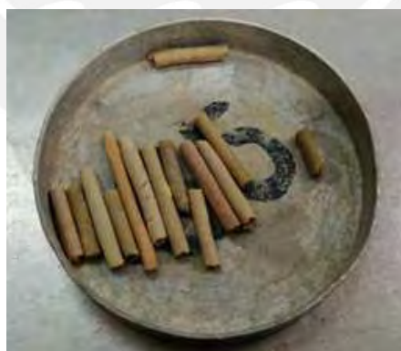
Figura 4.12: Muestras del ensayo de Límite Plástico secadas en el horno.
