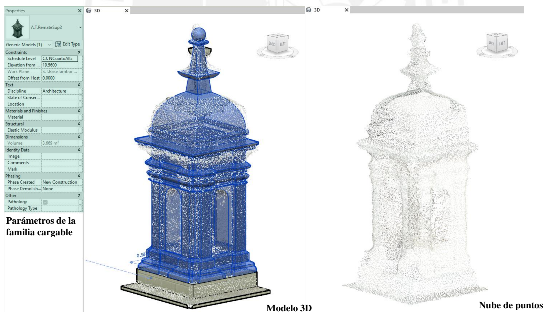
Fig. 3.3 Remate superior modelado como familia In-place a partir de la nube de puntos
