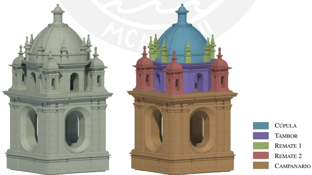
Fig. 4.15 Elementos arquitectónicos y estructurales de los campanarios de la iglesia
