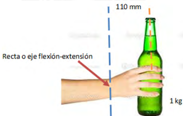
Figura 3.4 - Distancias del centro de masa de la botella a la recta o eje de flexión-extensión
