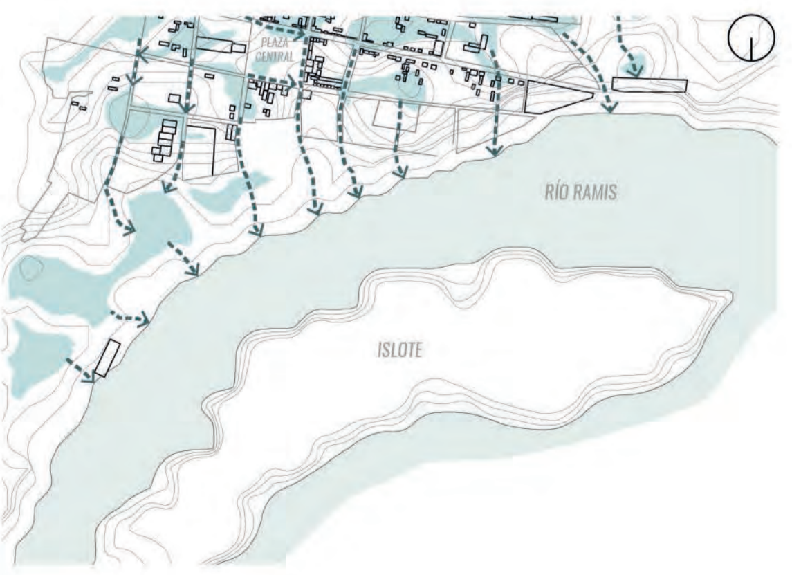
ZONAS DE DRENAJE DE AGUA DE LLUVIA
