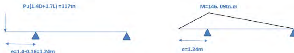
IMAGEN 11.10: DIAGRAMA DE MOMENTO FLECTOR PARA LA VIGA DE CIMENTACIÓN.
