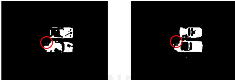
Figura 4.14. Izquierda.- El algoritmo arroja como resultado que el vehículo superior está inclinado 1.8 grados, mientras el inferior lo está 4.1 grados. Derecha.- El algoritmo arroja como resultado que el vehículo superior está inclinado 1.5 grados, mientras el inferior lo está 4.6 grados.
