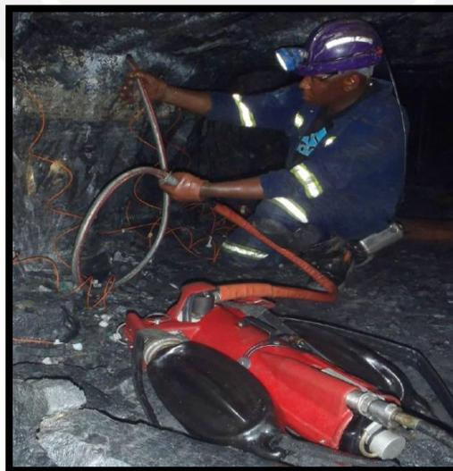
Figura 6. Carguío con el equipo Portable Charging Unit.
