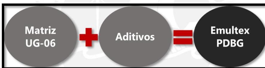
Figura 16. Componentes de la emulsión a granel Emultex PDBG.
