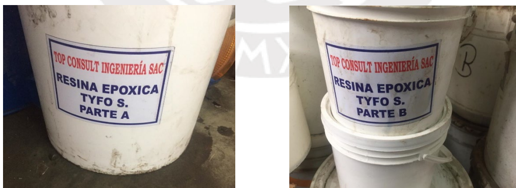
Figura B.2 Las dos partes de la resina epóxica que deben mezclarse
