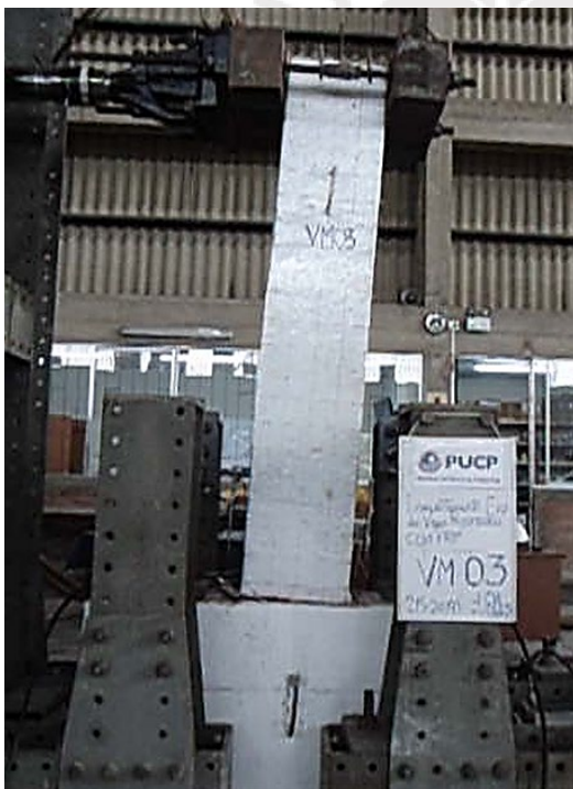
Figura 5.7 Mapa de fisuras de la viga VM-03
