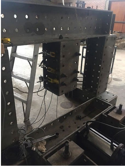
(c) Transductores de desplazamiento, LVDT, marca HBM, de diferentes carreras.
