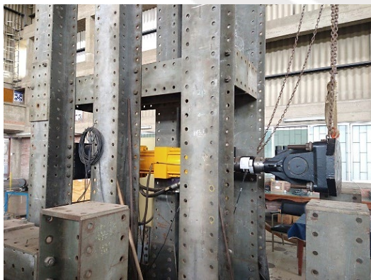
(a) Actuador Estructural, marca MTS (USA), modelo 204.81, Serie N°281, Capacidad 500 KN, Carrera +/- 150 mm, presión de trabajo 200 bar, Servocontrolado.
