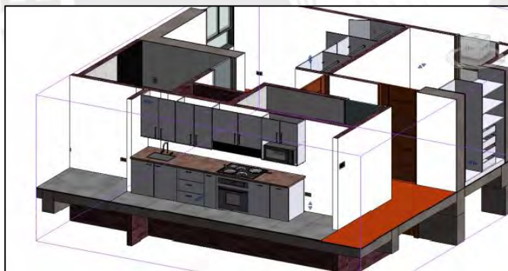
Figura 2-12 Modelo en LOD 400
