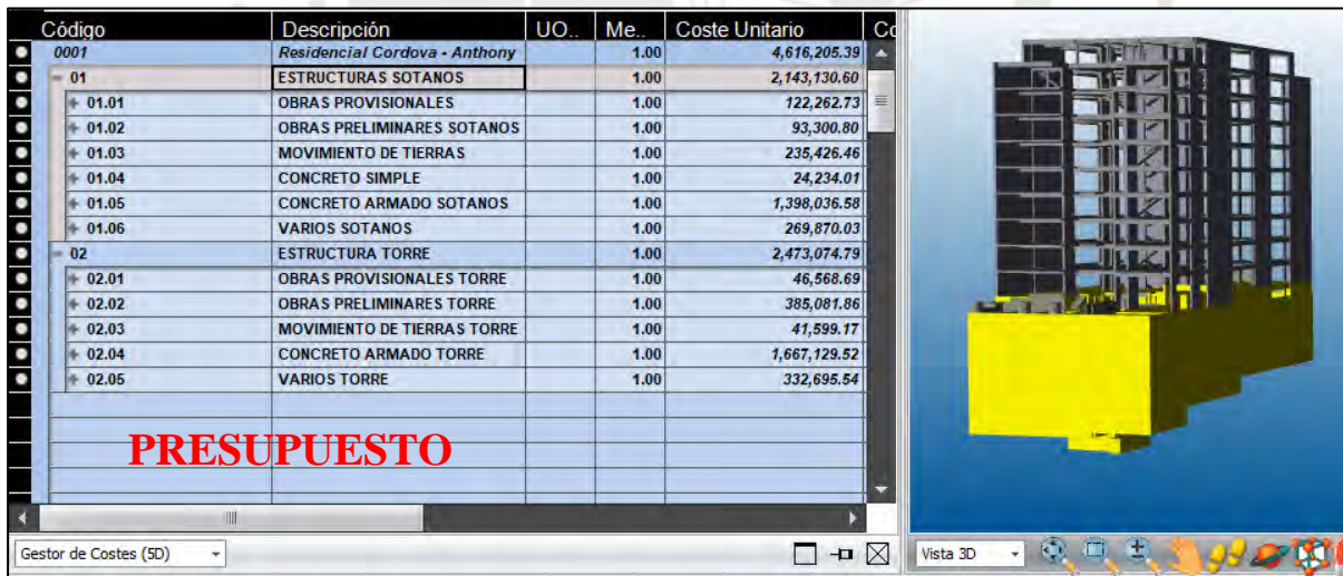
Figura 4-24 Estructura sótanos vinculada al presupuesto
