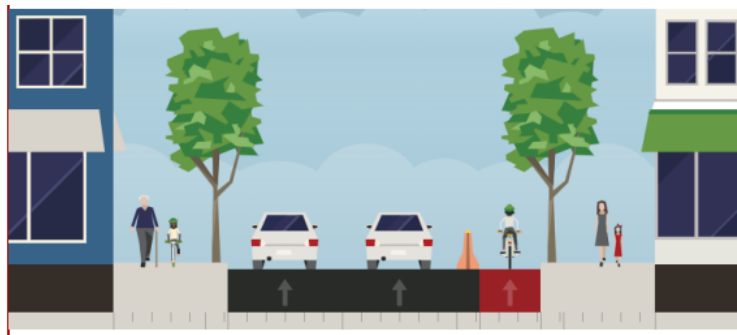
Figura 5. Ciclovía unidireccional en vía de un solo sentido
