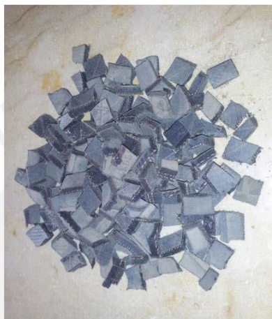
Figura 5.1: Astillas de llantas trituradas. Las dimensiones de cada una son 20 x 15 x 0.5 mm (Saberian y Rahgozar, 2016).
