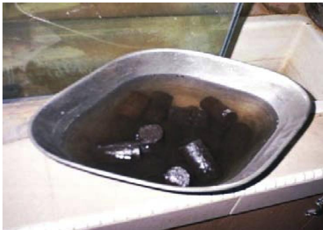
Figura 4.2: Muestras durante etapa de curado húmedo (Kalantari y Prasad, 2014).
