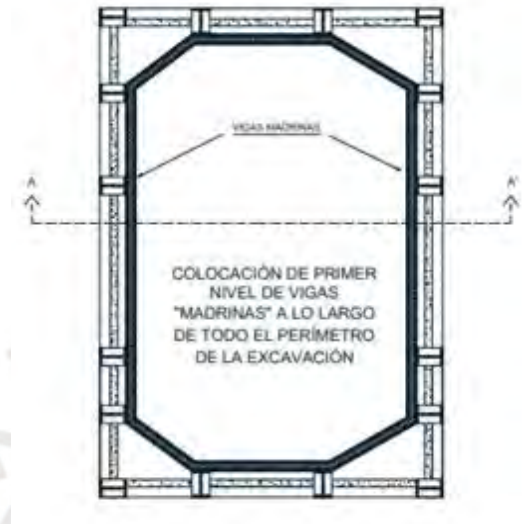
Figura 12. Apuntalamiento del primer nivel del muro de Berlín. (Gerdau, 2017)
