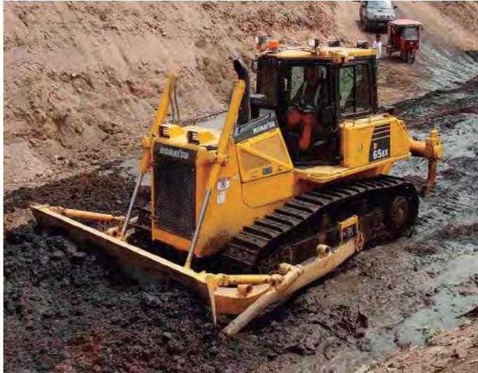
**Figura 4.7:** Tractor oruga. Fuente: CONSTRUVIAL S.A.
