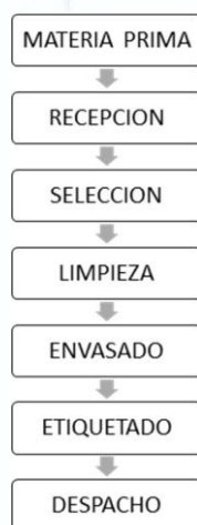
Figura 1. Unidades operativas de Vista del Valle. Muestra la secuencia de las unidades operativas en el proceso productivo: Adaptado de “Proceso de producción”, por Vista del Valle, s.f.
