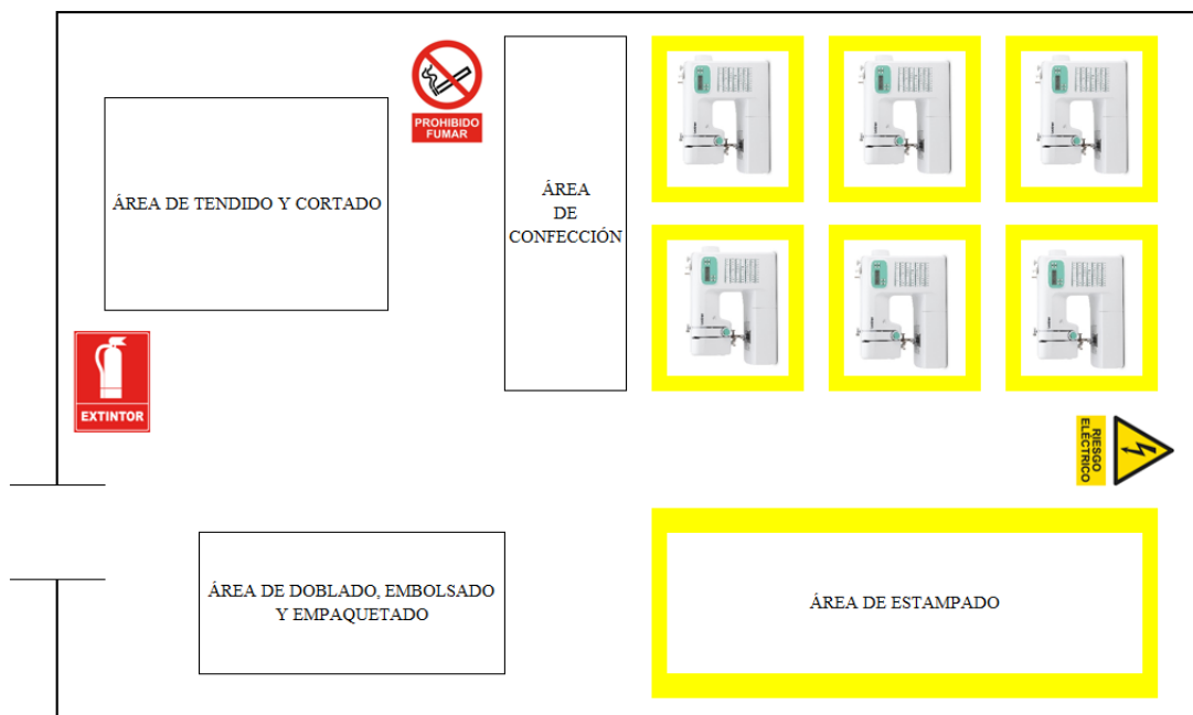
Figura 3.11: Demarcación y Señalización del área de producción
