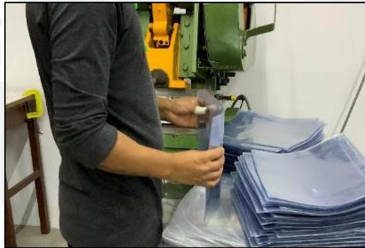
Figura 3.1: Operario colocando material en la actividad troquelado
