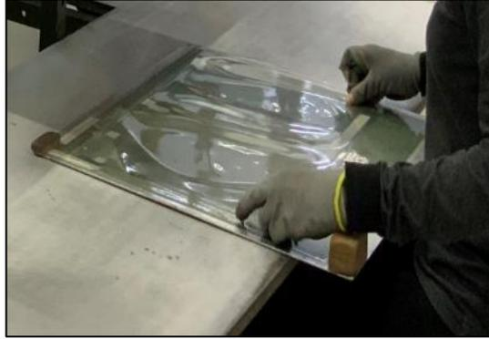
Figura 3.18: Operario colocando la pieza en la plataforma metálica
