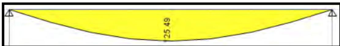
Figura 55 Diagrama de momentos flectores de viga solera(kg.m)
