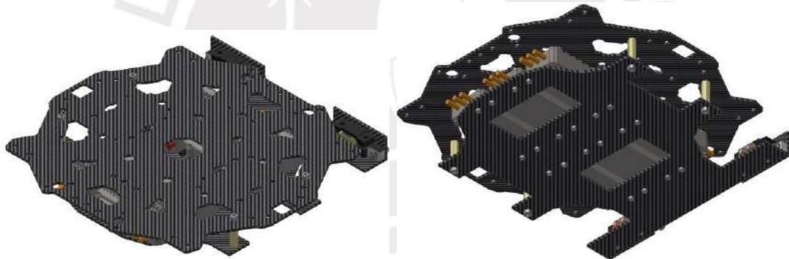
Figura 26. Montaje de placa de ESC a plato inferior del drone: a)Vista superior, b)Vista inferior
