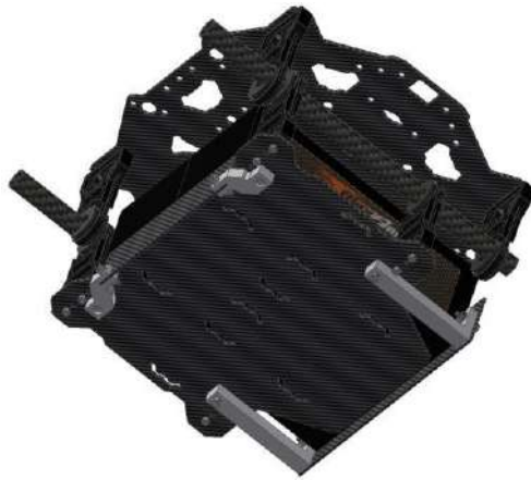
Figura 25. Vista inferior del porta-baterías soportado por el plato inferior del drone
