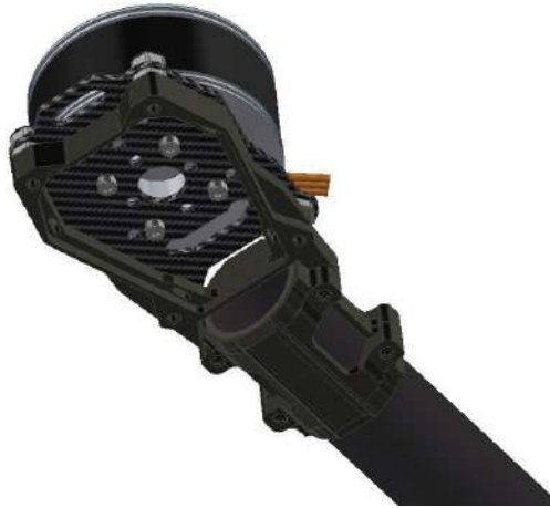
Figura 21. Montaje de motor brushless a brazo de drone
