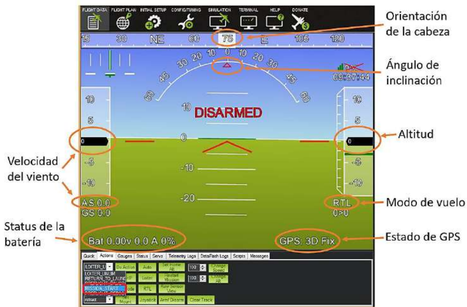
Figura 4.36. Parámetros observados en la pantalla “Flight Data” de Mission Planner
