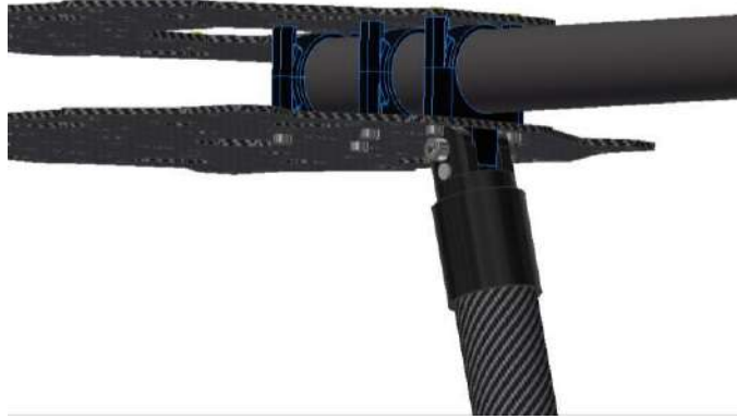
Figura 23. Montaje del tren de aterrizaje
