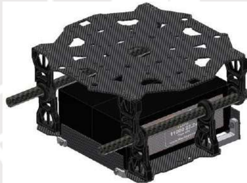
Figura 24. Vista superior del porta-baterías soportado por el plato inferior del drone
