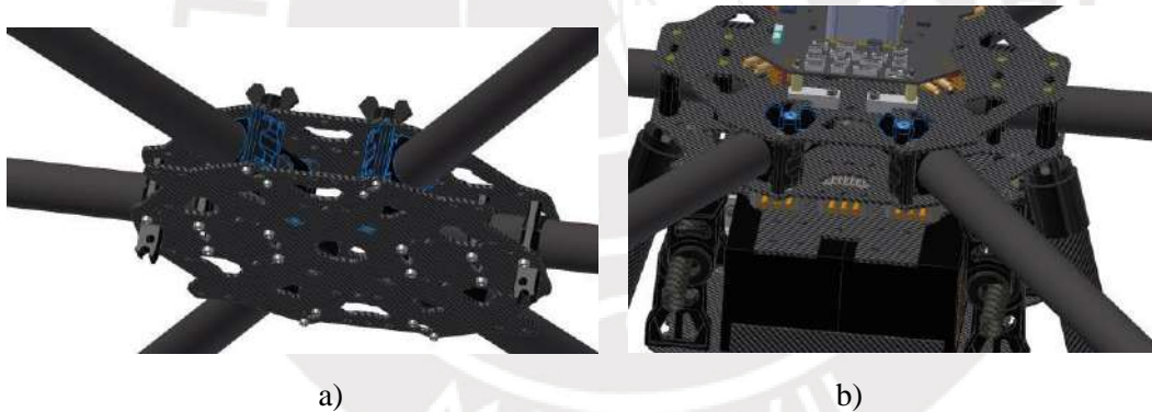
Figura 20. Montaje de brazos plegables: a)Abrazaderas, b)Pernos mariposa de Tarot
