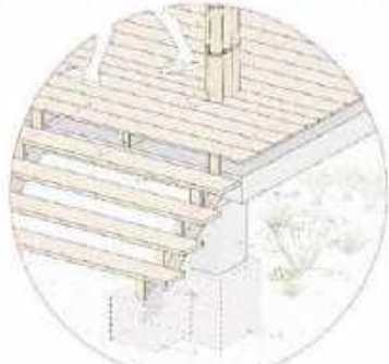
DETALLE 1 ENCUENTRO CIMIENTO, PLATAFORMA, COLUMNA Y ESCALERA
