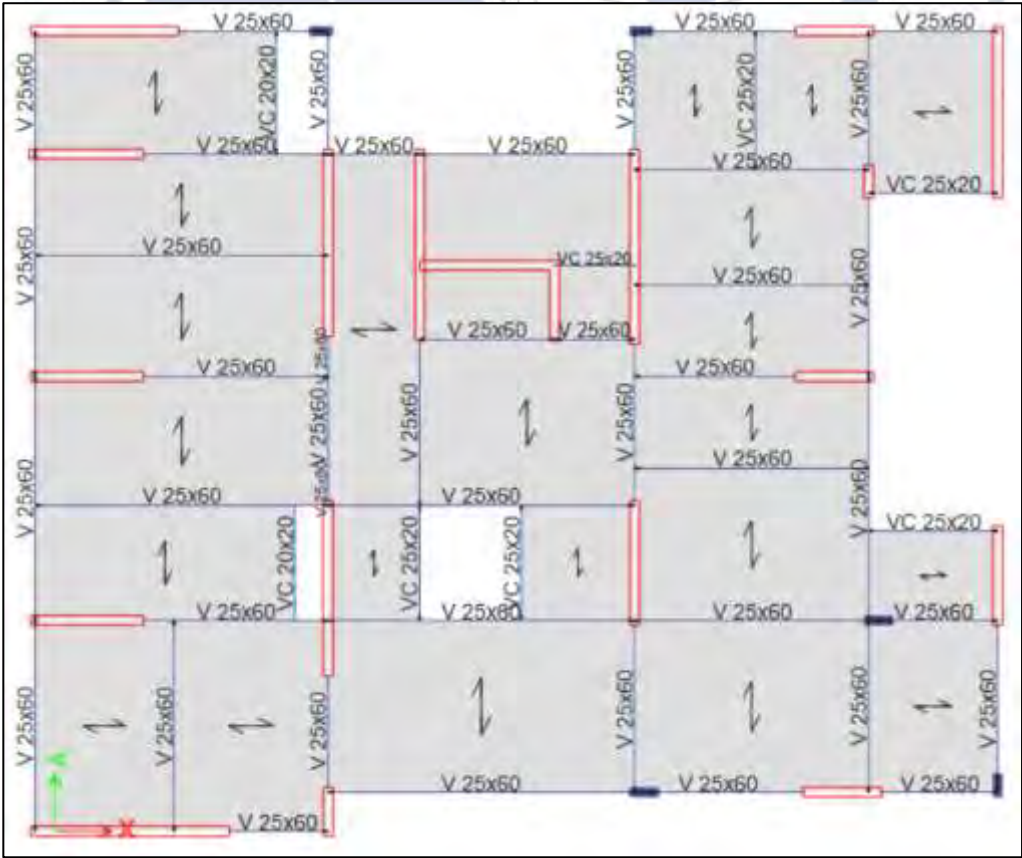
Figura 4-2 Modelo en Etabs vista de planta típica
