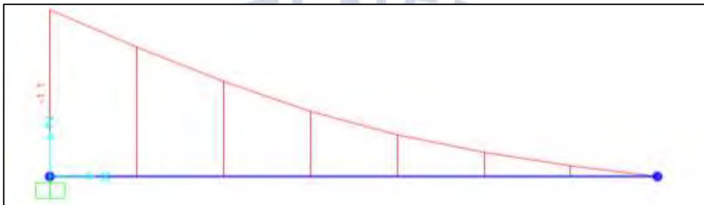
Figura 10-10 Diagrama de momento flector de columna de arriostre
