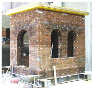
a) Confinamiento de estructuras de un piso
