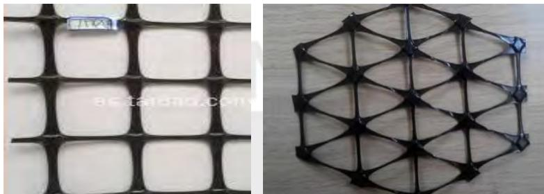
Figura 2.2 A la izquierda malla biaxial y a la derecha malla triaxial (Torrealva, D., 2014)
