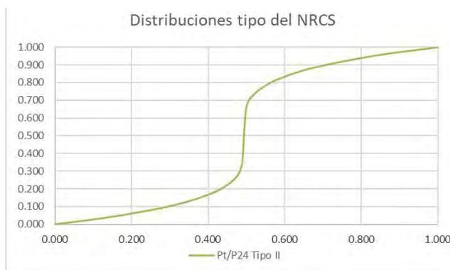
Figura 31 Distribuciones tipo del NRCS – Tormenta tipo II de 24 horas. Adaptado de Balbastre (2018). Análisis comparativo de metodologías de cálculo de tormentas de diseño para su aplicación en hidrología urbana.
