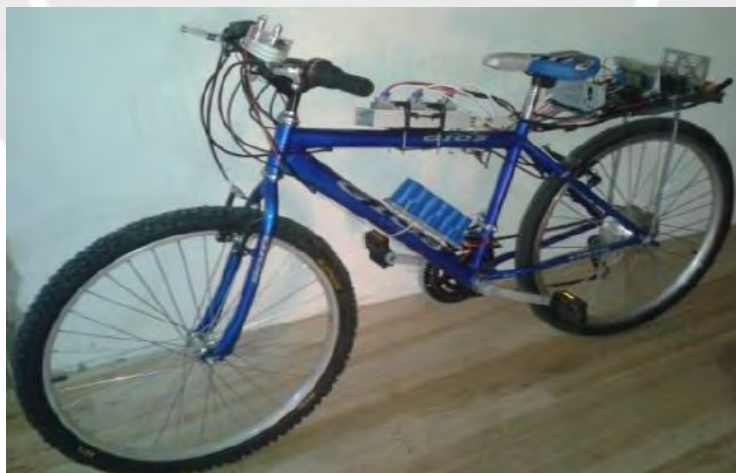
Figura 1.2: Freno regenerativo implementado en bicicleta 2 (Chunchi & Espinoza, 2015).
