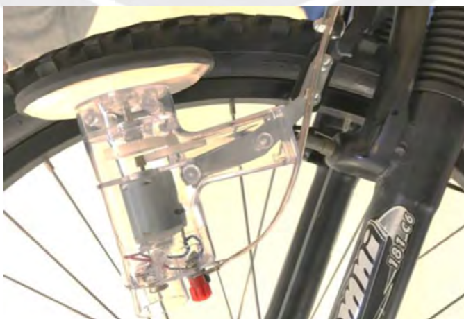
Figura 1.3: Freno regenerativo implementado en bicicleta 3 (Maheswaran et al., 2018).
