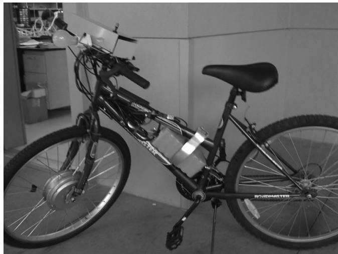
Figura 1.4: Freno regenerativo implementado en bicicleta 4 (Veerina, 2009).
