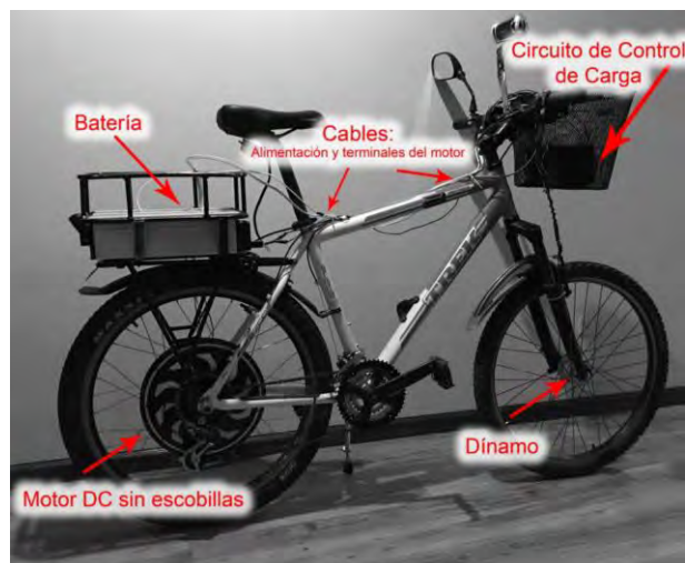
Figura 1.1: Freno regenerativo implementado en bicicleta 1 (Torral, 2019).
