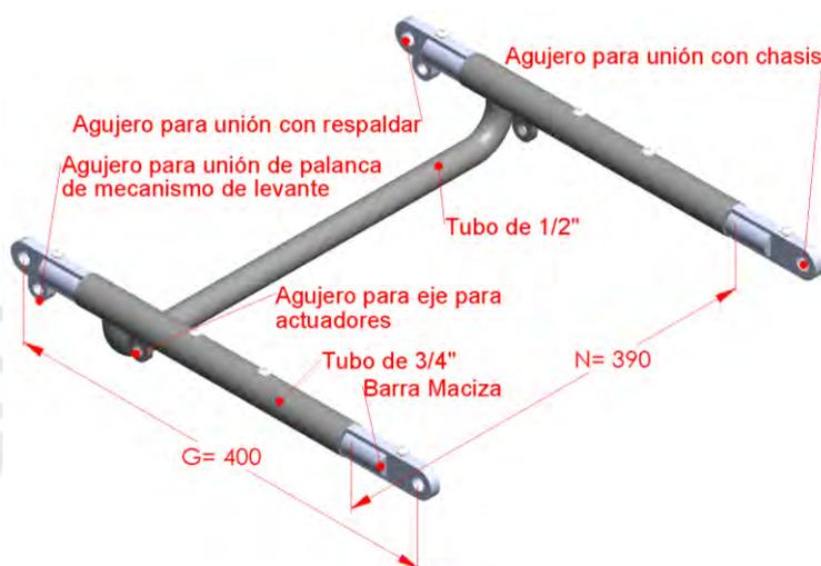
Figura 3.3 Estructura de asiento de silla de ruedas
