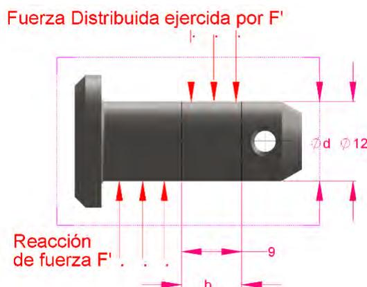
Figura 3.38 Fuerzas distribuidas en el pin de la articulación entre respaldar y biela
