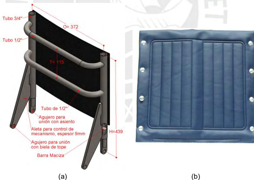
Figura 3.5 (a) Estructura de respaldar de silla de ruedas. (b) Tapicería de vinilo del respaldar<sup>39</sup>.
