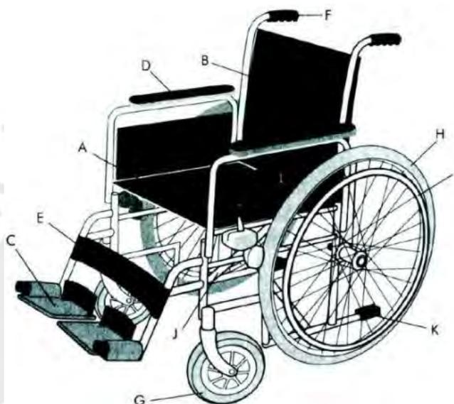
Figura 1.13 Componentes de la Silla de Ruedas<sup>16</sup>
