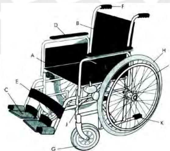
Figura 1.5 Silla de Ruedas propulsada manualmente<sup>8</sup>
