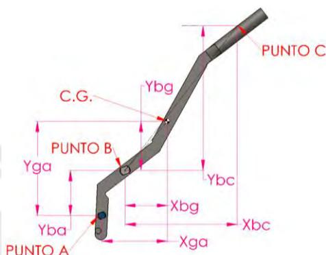
Figura 3.26 Distribución de medidas respecto al centro de gravedad del Elemento S1
