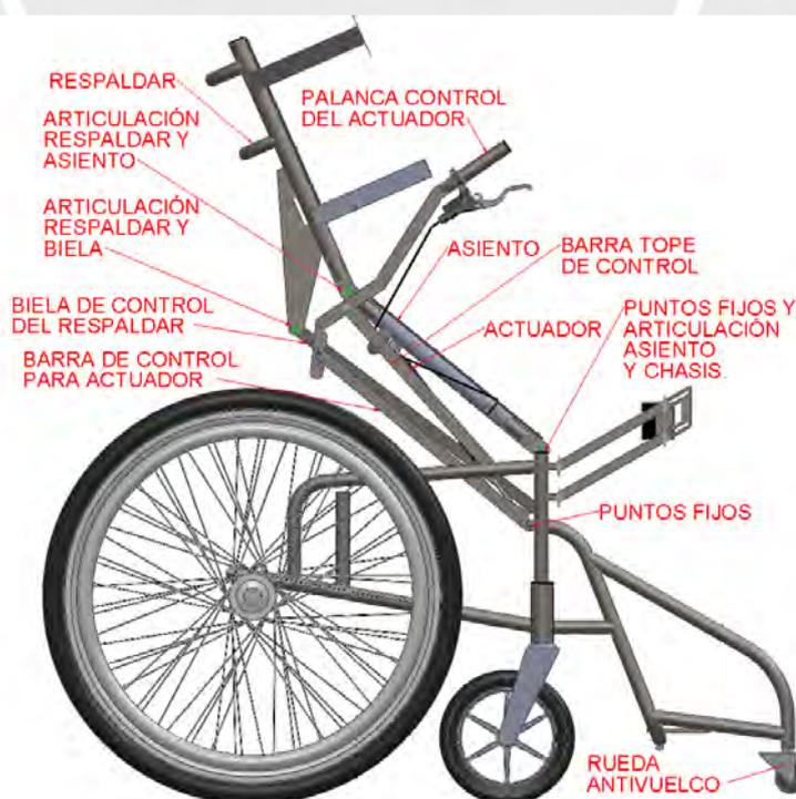
Figura 3.21 Partes principales de la silla de ruedas
