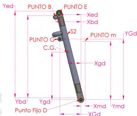
Figura 3.27 Distribución de medidas respecto al centro de gravedad del Elemento S2
