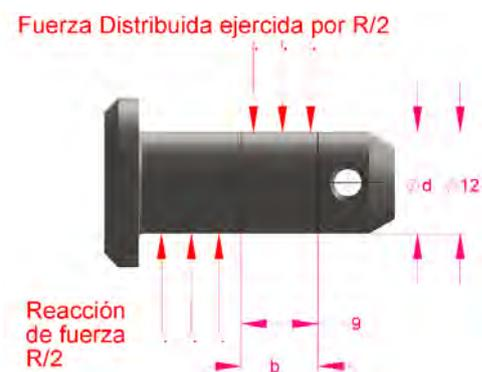
Figura 3.36 Diagrama de cuerpo libre en el pin de la articulación entre asiento y chasis.
