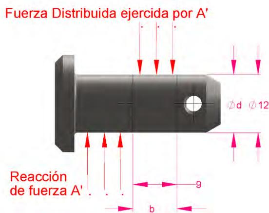
Figura 3.34 Diagrama de cuerpo libre en el pin de la articulación entre asiento y respaldar.
