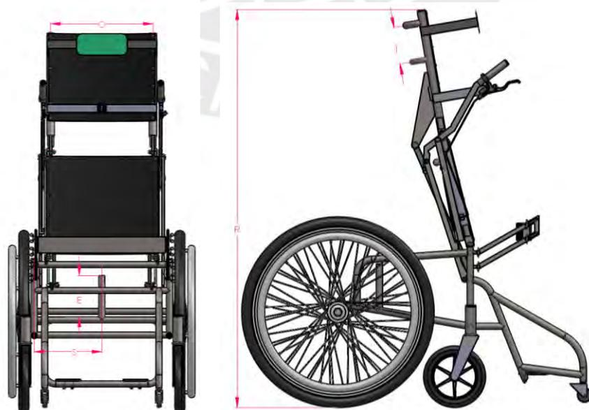
Figura 3.2 Esquema de la silla de ruedas en posición Bípeda y sus medidas geométricas
