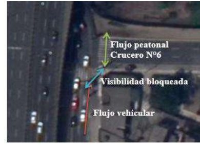
Figura 4.15: Vista en planta del problema de visibilidad Tomado de Google Earth (Adaptado)
