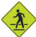
Figura 6.2: Señal proximidad de cruce peatonal
