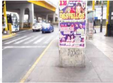
Figura 4.14: Muro de concreto bloquea la visibilidad
