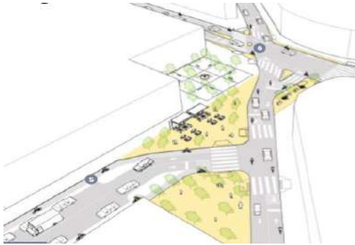
Figura 2.27: Recuperación del espacio público en intersecciones complejas Tomado de “Urban Street Design Guide”, por NACTO (2013)
