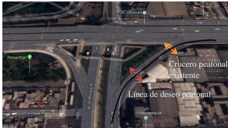
Figura 4.5: Imagen aérea de la intersección que muestra la línea de deseo peatonal y el cruceo peatonal existente.
