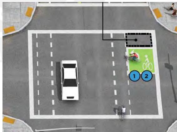
Cajón bici, ubicado antes de una intersección semaforizada
