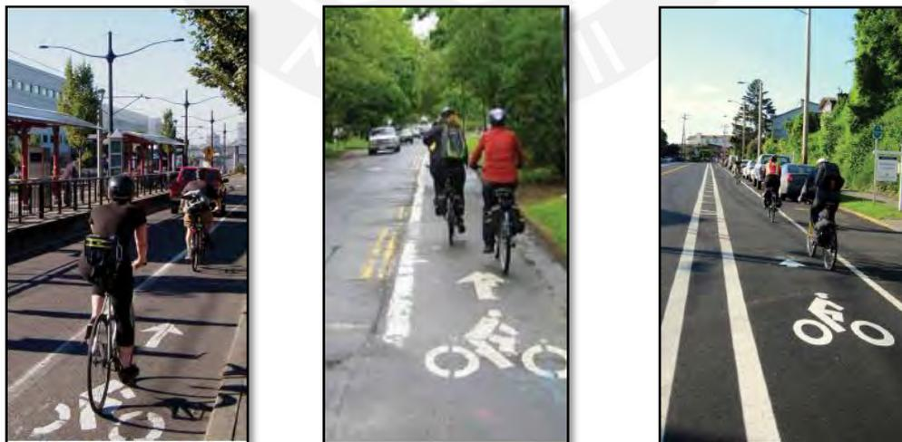
*Figura N°11: Ciclo carril en la dirección del tráfico vehicular (izquierda), en dirección contraria (intermedia) y con separación adicional (derecha)*
