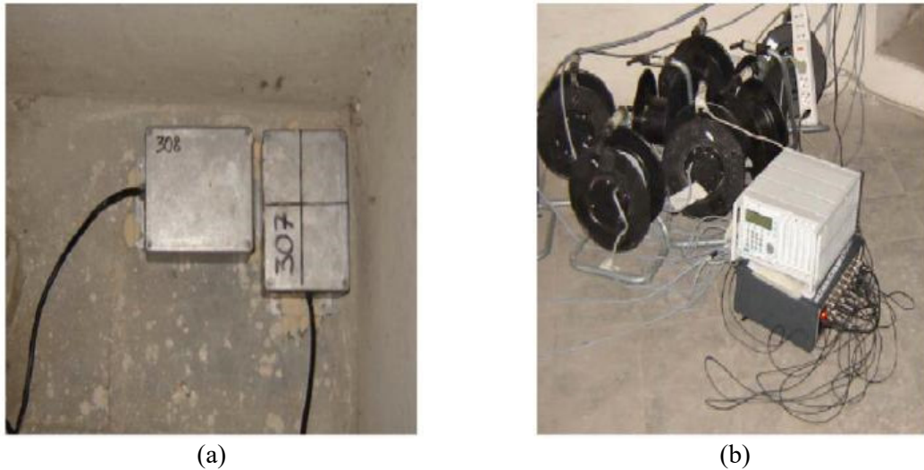
Figura 2.9 Equipamiento usado para los ensayos de vibración ambiental: (a) acelerómetros uniaxiales y (b) tablero de adquisición de datos (Foti et al., 2012).
