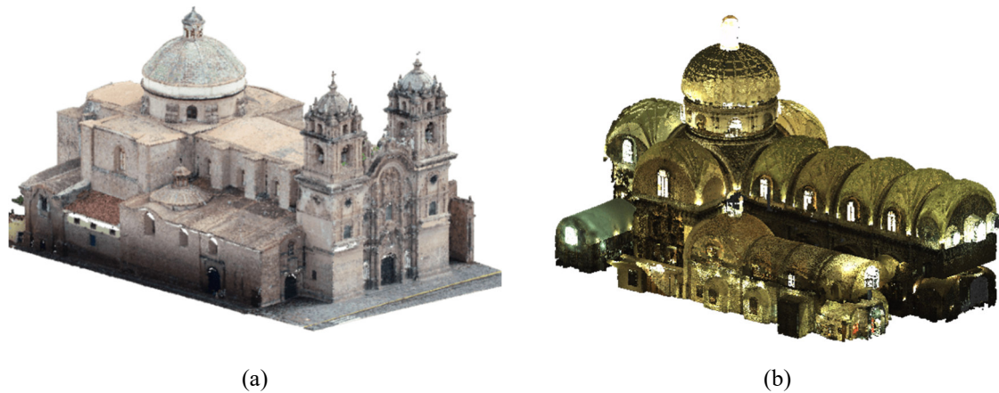
Figura 4.1 Nube de puntos híbrida de (a) la fotogrametría aérea y (b) el escaneo láser terrestre.
