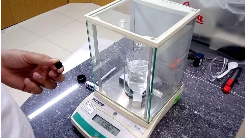
Figura 4.1. Equipo de ensayo de gravedad específica ASTM D792.
