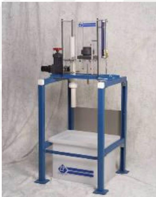
Figura 4.5. Dispositivo de ensayo de permeabilidad para medir la permitividad del geotextil.
