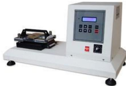
Figura 4.6. Equipo de ensayo de resistencia a la abrasión para geotextiles..
