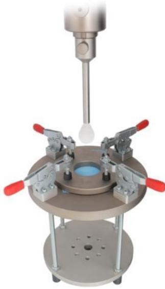
Figura 4.15. Equipo para el ensayo de punzonamiento de geomembranas según ASTM D4833.
