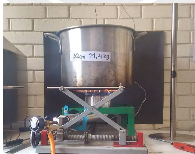
Figura 4.28 Ensayo de rendimiento térmico ( P_g = 28 mbar, h = 30 mm, GLP)
