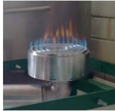
Figura 4.16 Prueba de distancia entre inyector y mezclador N°2 (GLP)
