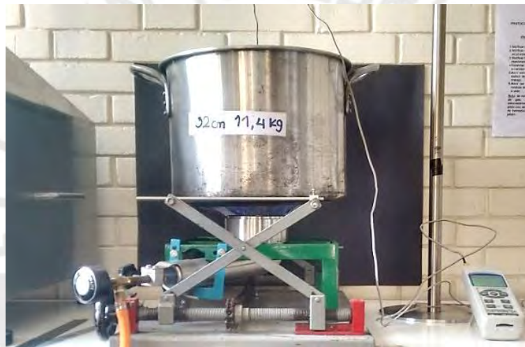
Figura 4.37 Ensayo de rendimiento térmico ( P_g = 23 mbar, h = 30 mm, Gas Natural)
