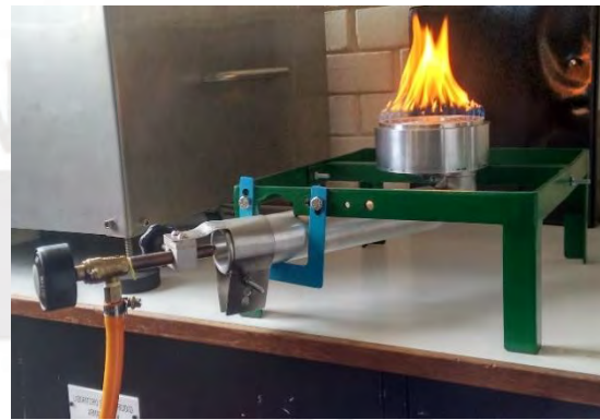
Figura 4.6 Prueba de inyector N° 4 utilizando GLP
