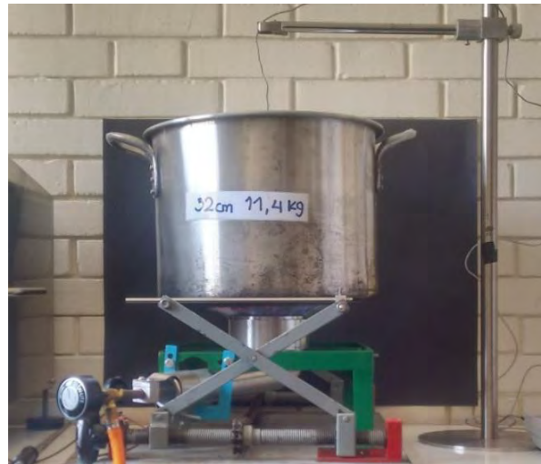
Figura 4.26 Ensayo de rendimiento térmico ( P_g = 28 mbar, h = 20 mm, GLP)
