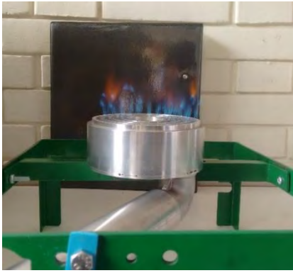
Figura 4.3 Prueba de inyector N° 1 utilizando GLP
