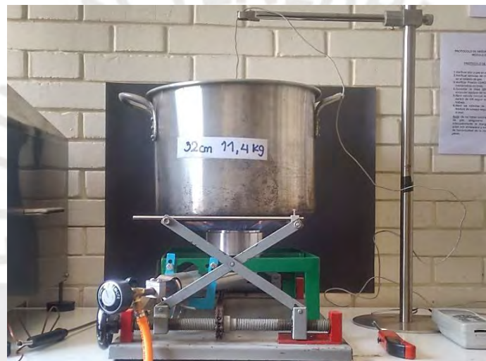
Figura 4.30 Ensayo de rendimiento térmico ( P_g = 60 mbar, h = 25 mm, GLP)
