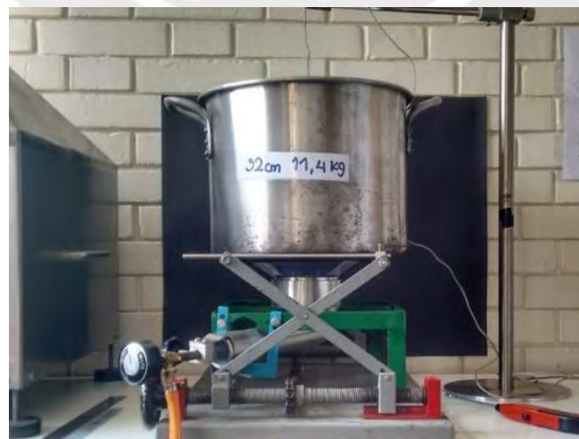
Figura 4.38 Ensayo de rendimiento térmico ( P_g = 23 mbar, h = 35 mm, Gas Natural)
