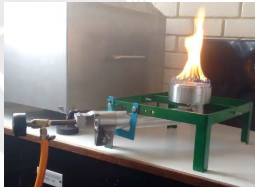
Figura 4.7 Prueba de inyector N° 5 utilizando GLP
