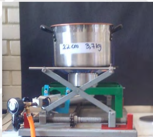
Figura 4.21 Quemador diseñado durante el precalentamiento
