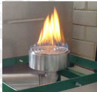
Figura 4.20 Prueba de distancia entre inyector y mezclador N°6 (GLP)
