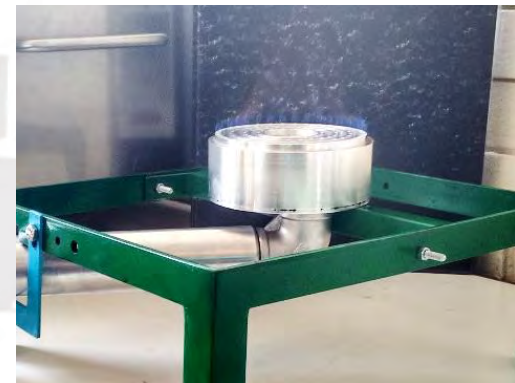
Figura 4.11 Prueba de inyector N° 4 utilizando Gas Natural
