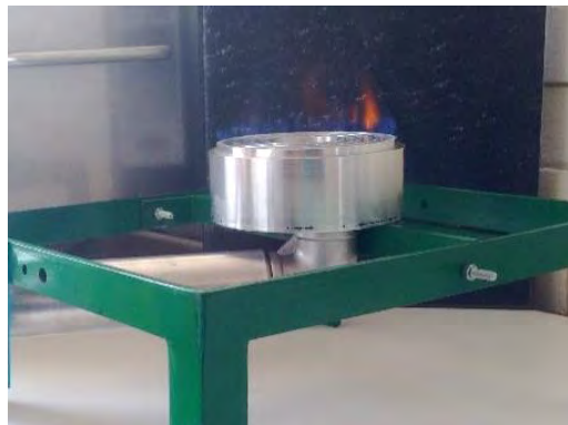
Figura 4.10 Prueba de inyector N° 3 utilizando Gas Natural
