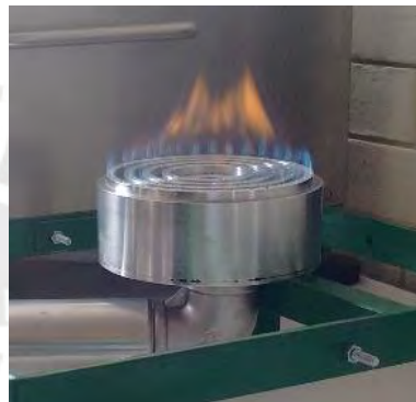
Figura 4.18 Prueba de distancia entre inyector y mezclador N°4 (GLP)
