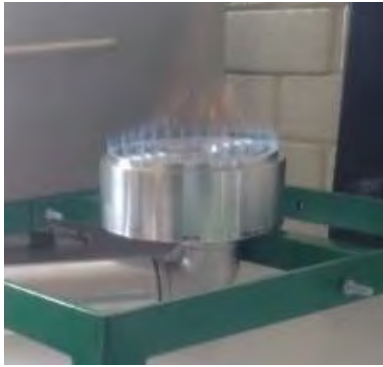
Figura 4.15 Prueba de distancia entre inyector y mezclador N°1 (GLP)
