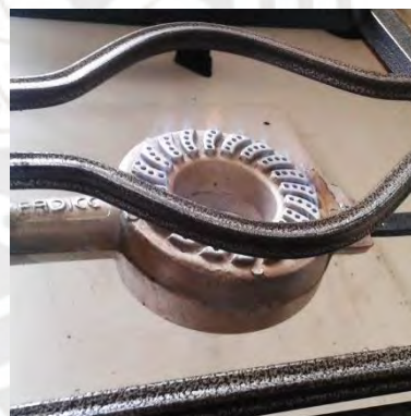
Figura 2.21 Quemador de la cocina FADIC (Vista lateral)
