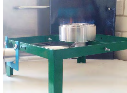
Figura 4.9 Prueba de inyector N° 2 utilizando Gas Natural
