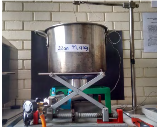
Figura 4.29 Ensayo de rendimiento térmico ( P_g = 40,1 mbar, h = 25 mm, GLP)
