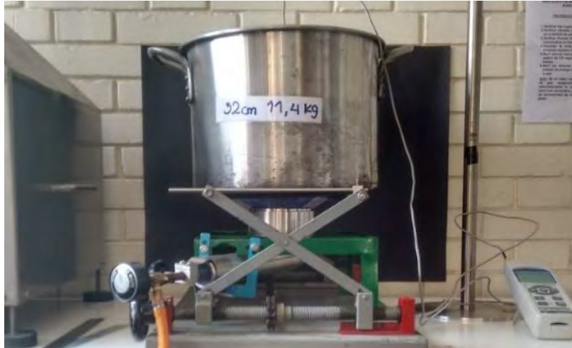
Figura 4.36 Ensayo de rendimiento térmico ( P_g = 23 mbar, h = 25 mm, Gas Natural)
