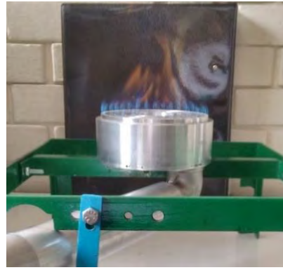
Figura 4.4 Prueba de inyector N° 2 utilizando GLP
