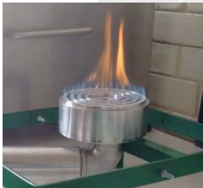
Figura 4.19 Prueba de distancia entre inyector y mezclador N°5 (GLP)
