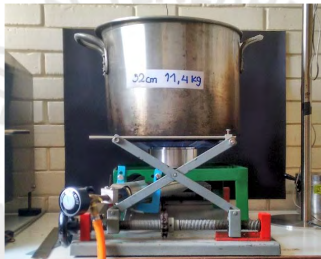
Figura 4.27 Ensayo de rendimiento térmico ( P_g = 28 mbar, h = 25 mm, GLP)
