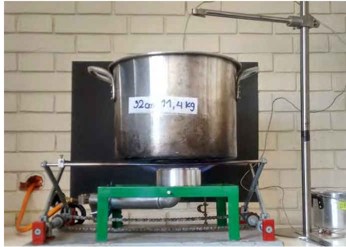
Figura 4.39 Ensayo de rendimiento térmico ( P_g = 34,4 mbar, h = 25 mm, Gas Natural)
