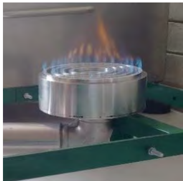
Figura 4.17 Prueba de distancia entre inyector y mezclador N°3 (GLP)
