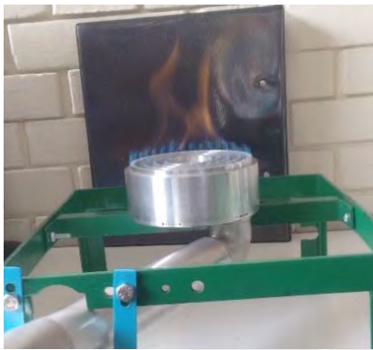
Figura 4.5 Prueba de inyector N° 3 utilizando GLP
