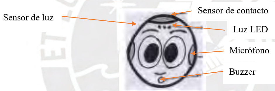
Figura 28. Esquema general de Parte Extraíble
