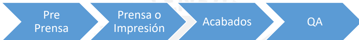
Ilustración 3.3.1 Principales procesos para la fabricación de etiquetas autoadhesivas
