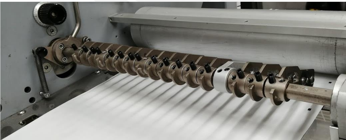
Ilustración 4.2.12 Eje de cuchillas con prisioneros de 3mm nuevos
