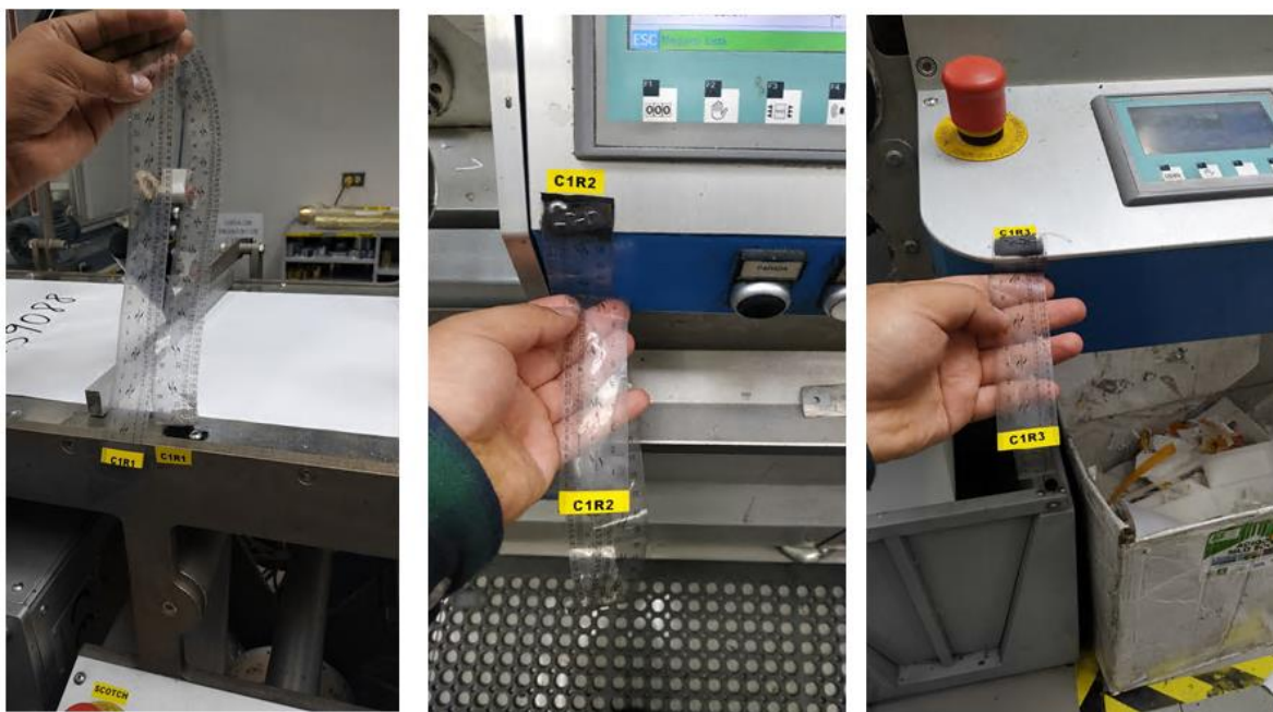
Ilustración 4.2.14 Reglas codificadas ubicadas en secciones de la máquina
