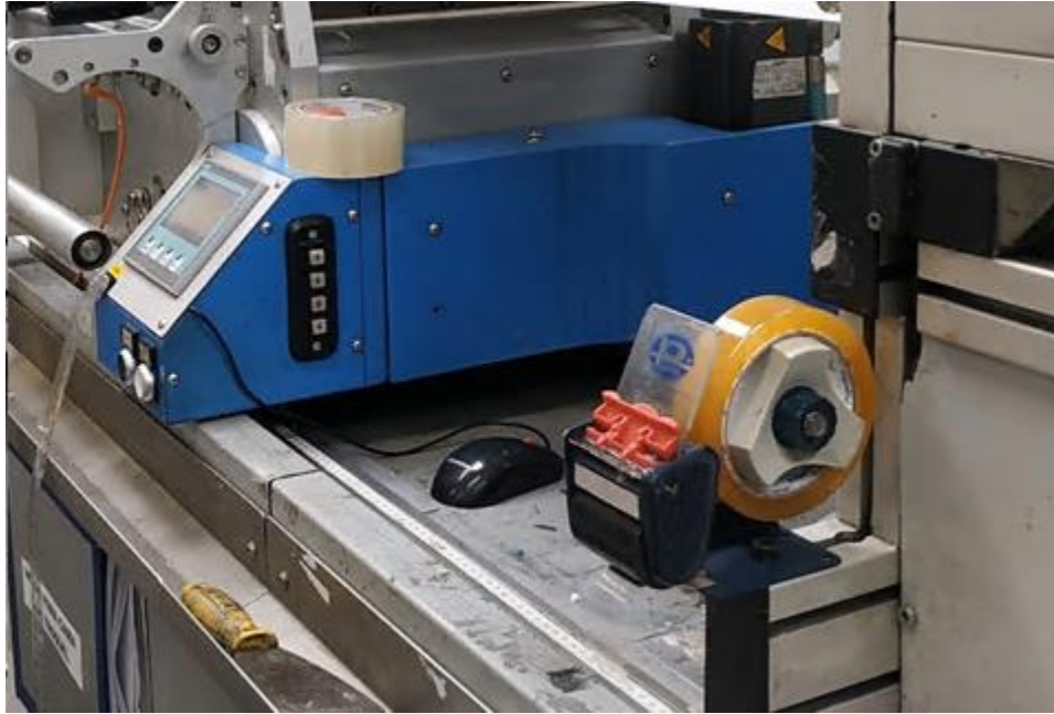
Ilustración 4.2.13 Dispensador de cinta acondicionado a la máquina
