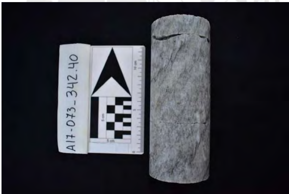
Muestra de color gris oscuro compuesta por anhidrita masiva con abundantes niveles milimétricos discontinuos de un material negro de granulometría fina.
