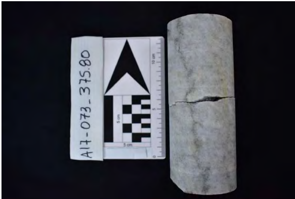
Muestra de color blanco grisáceo compuesta por anhidrita masiva de color blanco con niveles milimétricos discontinuos de un material negro de granulometría fina.
