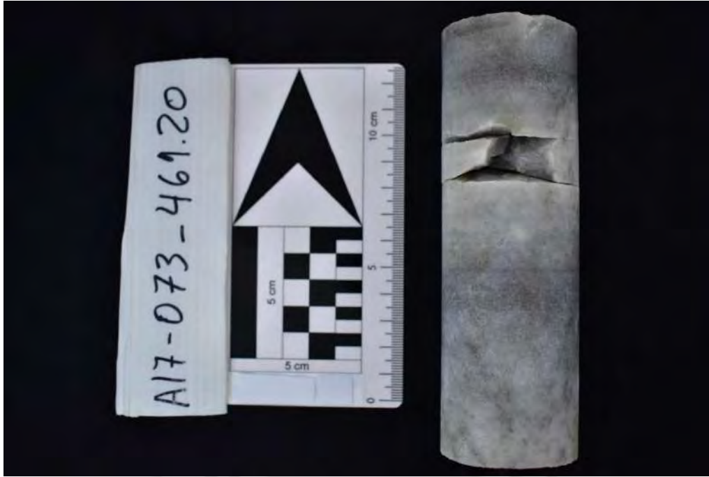
Muestra de color gris compuesta por anhidrita masiva y en cristales elongados de hábito tabular y de niveles milimétricos discontinuos de un material negro de granulometría fina.
