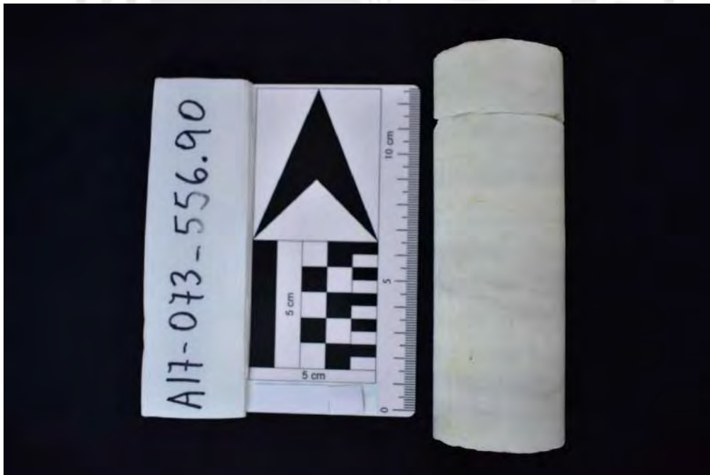
Muestra de color blanco compuesta por anhidrita masiva y en cristales elongados de hábito tabular.
