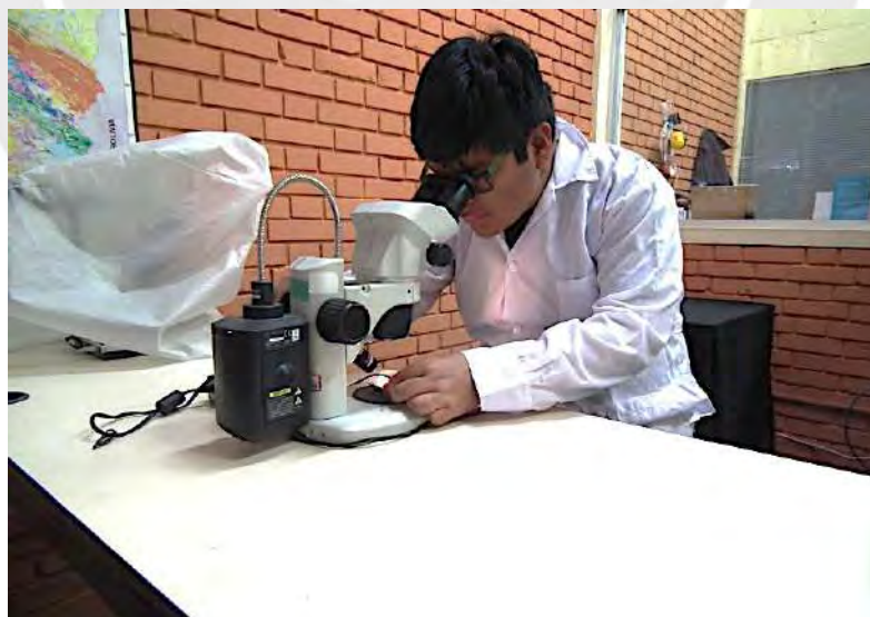
Figura 11. Fotografía del microscopio binocular empleado para la inspección visual de las secciones pulidas a muestrear para el presente estudio isotópico.
