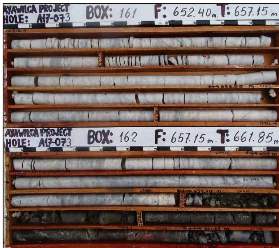
Figura 10. Fotografía de la anhidrita masiva (color blanco) interceptada por el taladro de perforación A17-073 (18 S 334459E 8846615N). Notar el contacto abrupto con la mineralización masiva de sulfuros (color negro).
