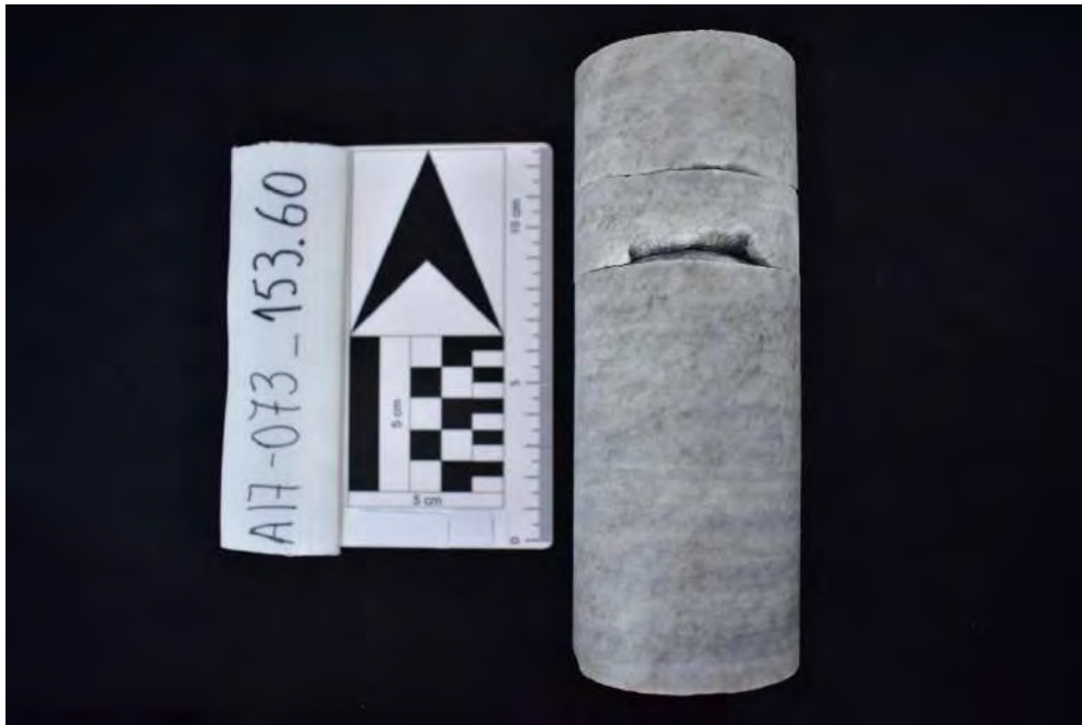
Muestra de color gris claro compuesta por anhidrita con niveles milimétricos discontinuos de un material negro de granulometría fina.
