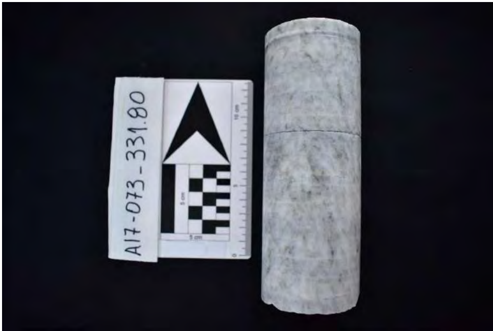
Muestra de color blanco grisáceo compuesta por anhidrita masiva con niveles milimétricos discontinuos de un material negro de granulometría fina.
