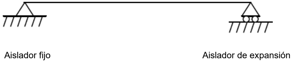
Figura 2.9: Representación común de los aisladores fijos y de expansión en un puente.
