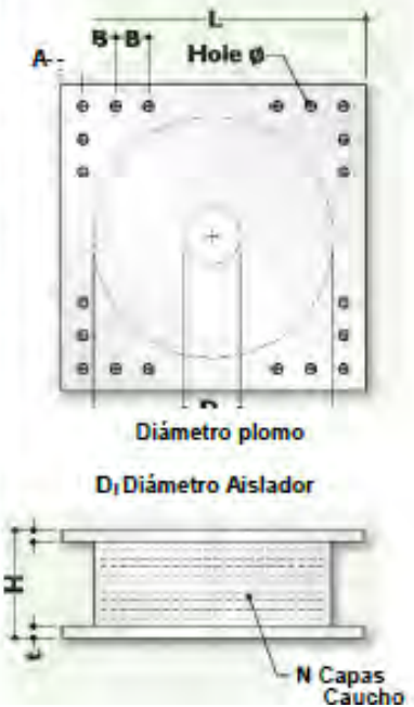
Figura 4.2: Catálogo DIS de las propiedades de un aislador según su dimensionamiento. DIS(2007).
