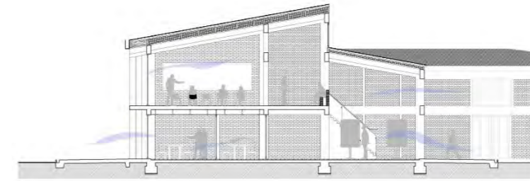
CORTE AA DIAGRAMA DE VENTILACIÓN NATURAL
