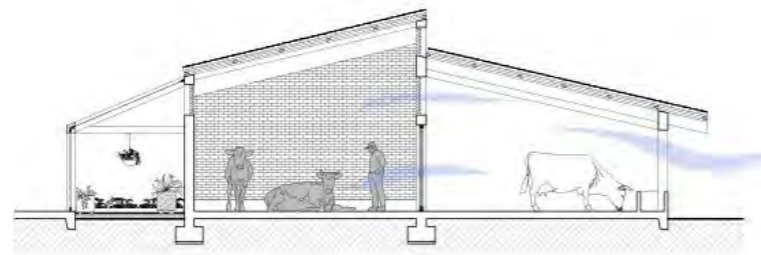
CORTE CC DIAGRAMA DE VENTILACIÓN NATURAL
