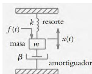
**Figura 36:** Sistema masa – resorte amortiguador.
