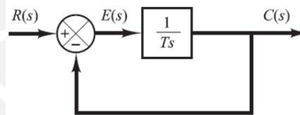
**Figura 32:** Diagrama de bloques de un sistema de primer orden.
