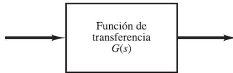
**Figura 19:** Elementos de un diagrama de bloques.
