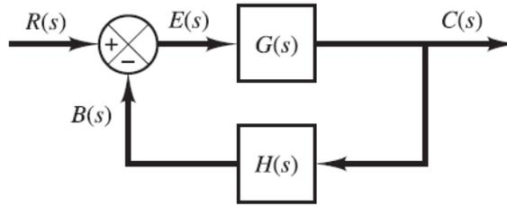
**Figura 39:** Sistema en lazo cerrado adaptado.
