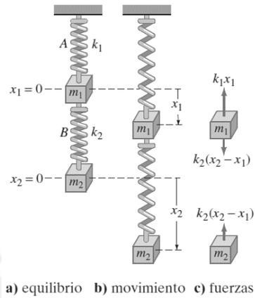
**Figura 8:** Sistema resorte - masa acoplado.
