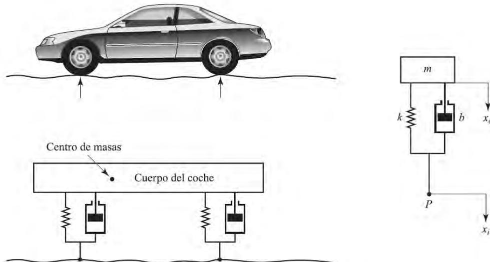
**Figura 43:** Sistema de suspensión de un automóvil-sistema de suspensión simplificado.
