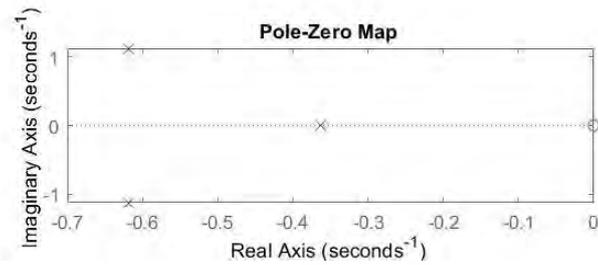
**Figura 49:** Gráfico de los polos del sistema de control.
