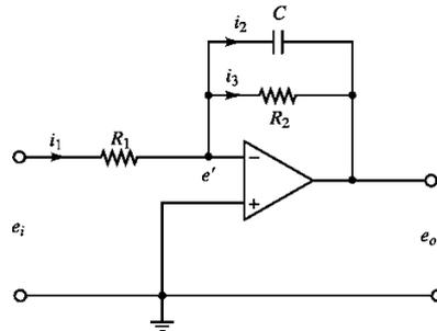
**Figura 41:** Circuito de retardo de primer orden utilizando un amplificador operacional.
