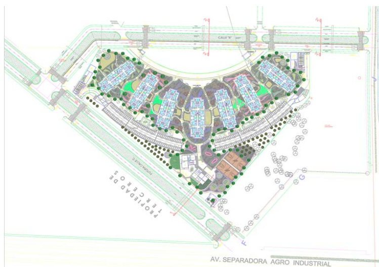
Fig.2: Distribución de torres de la Villa Panamericana Construcción de vivienda, agua y saneamiento (2019: s/p)
