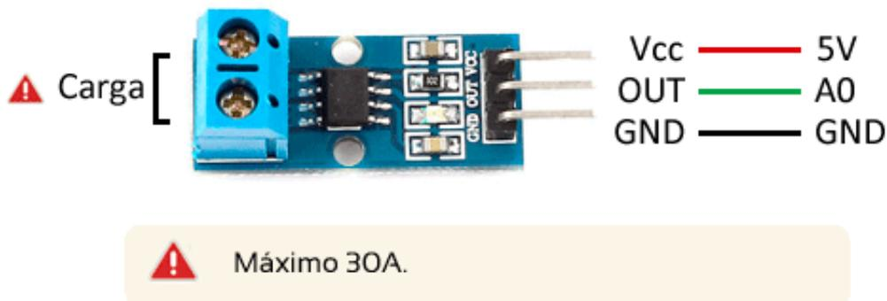
Figura 1.15: Esquema de conexión del sensor ACS712. Fuente: [19]
