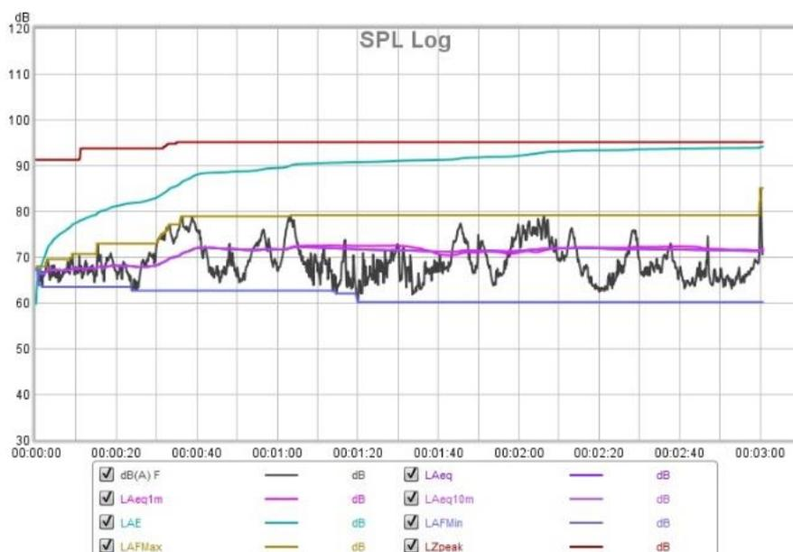
La presente gráfica muestra la variación del nivel de presión sonora (dBA con ponderación *fast*) en el tiempo. Para fines del estudio se analiza el  $L_{Aeq}$  para cada periodo de medición.
