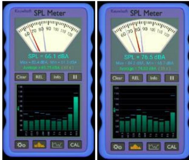
Figura 4-2 SPL en andén sin tren y con tren – Estación Caja de Agua
