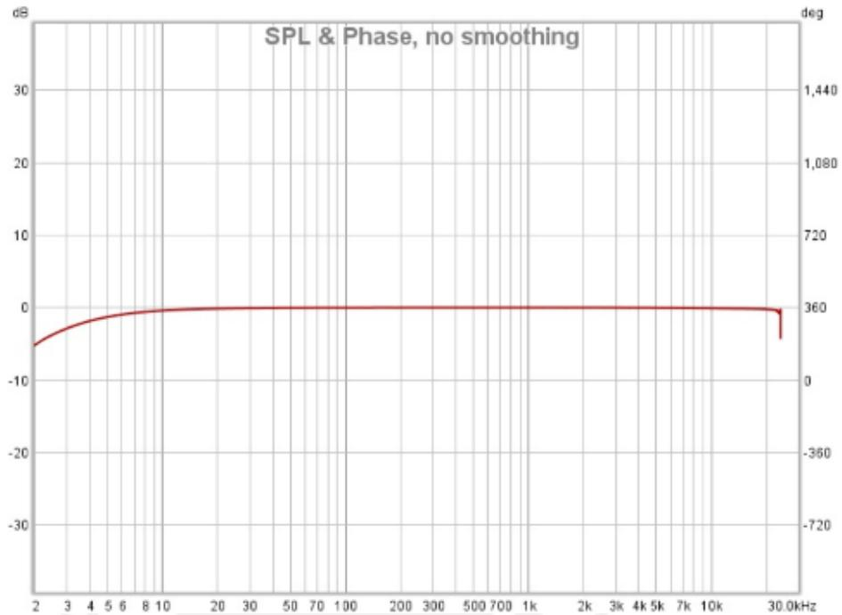
Figura 3-5 Calibración de la interfaz de audio
