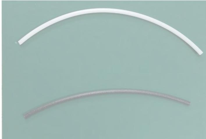
Figura 2.15.- Filamento de PA (superior) y PA/CF (inferior) para el ensayo de tracción.
