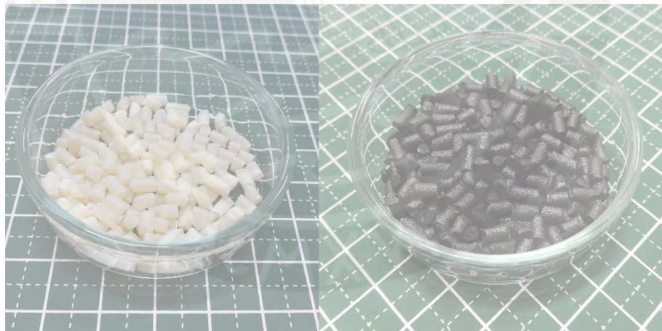
Figura 2.11.- Granzas de filamento de PA (izquierda) y PA/CF (derecha).
