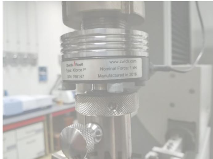
Figura 2.24.- Celda de carga de 1kN.
