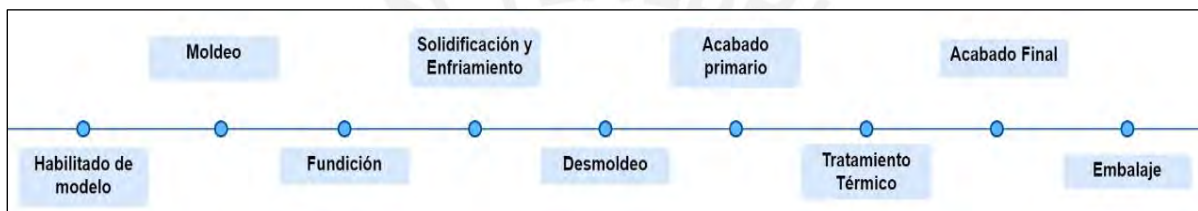
Figura 9: Proceso de fabricación de la familia SAG.
