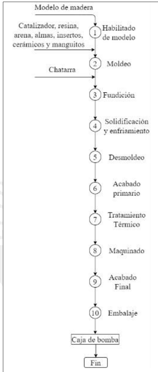
Figura 4. DOP de la caja de bomba.
