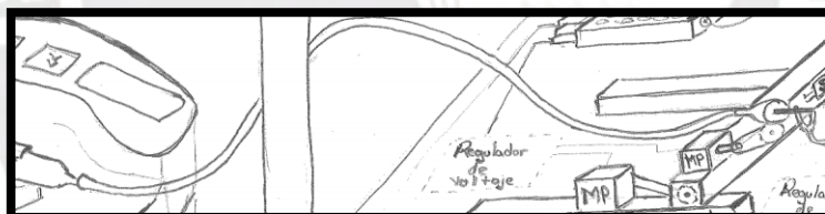
Figura C4: Boceto del recorrido de la manguera de silicona que transporta la solución biopolimérica. Fuente: Elaboración propia.
