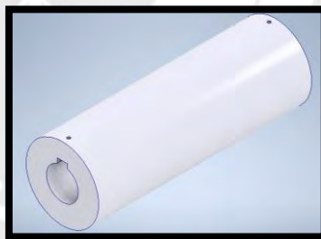
Figura N° 5-8: Capa interna del cilindro colector rotatorio. Fuente: Elaboración propia.
