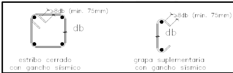
Figura 2 Gancho en estribos y grapas suplementarias con responsabilidad sísmica
