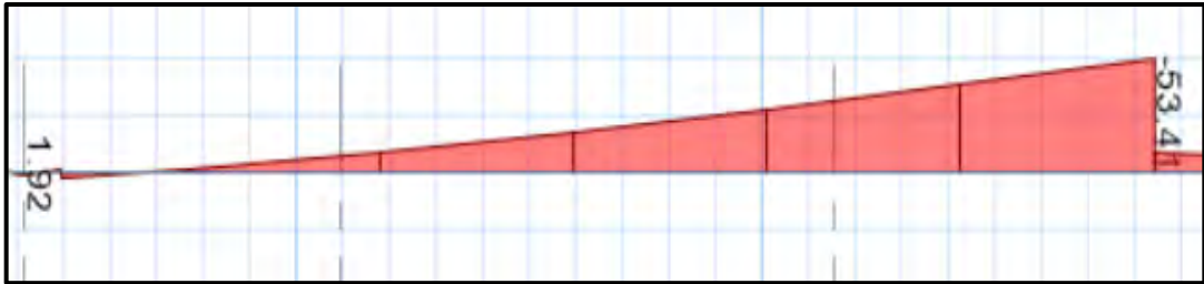
Figura 84 Diagrama de momento flector de VC-1
