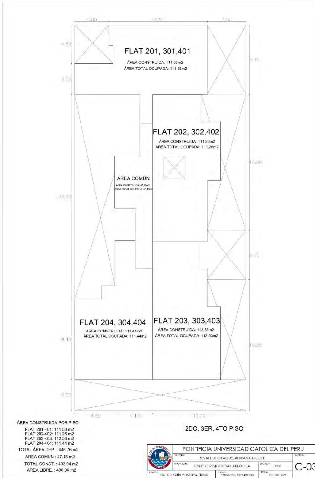
Figura 21. Plano de cabida arquitectónica, planta típica
