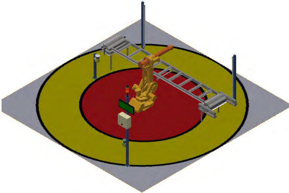
Figura 3. 11 Modelo 3D del sistema en una aplicación de brazo robótico frente a una faja Fuente: Elaboración Propia
