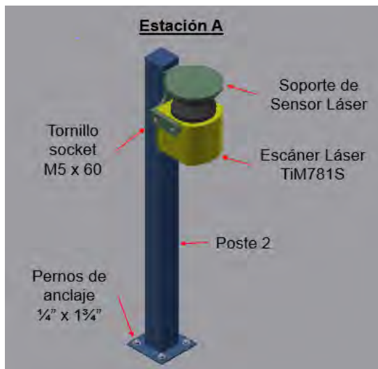
Figura 3. 12 Modelo 3D de la Estación A Fuente: Elaboración Propia
