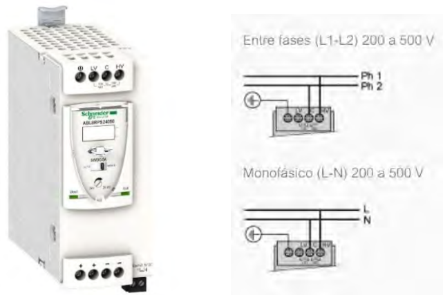
Figura 3. 8 Fuente ABL8RPS24050 5A y conexiones Fuente: Schneider Electric 23
