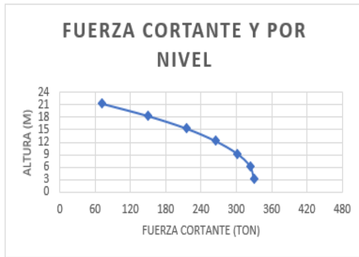
Ilustración 10 - Distribución de cortante por altura en Y
