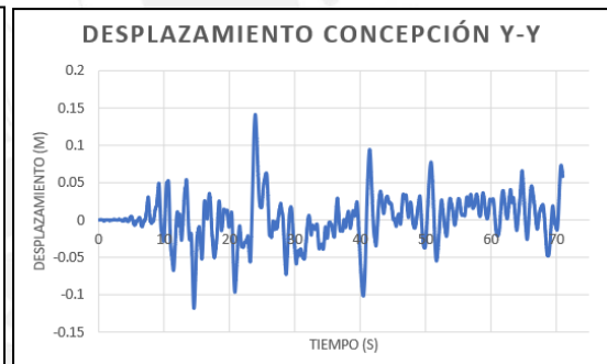
Figura 82 - Cortante basal y desplazamiento debido a la señal de Concepción (y-y)
