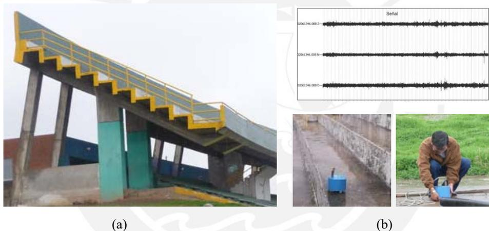
Figura 20. Análisis en el dominio del tiempo: (a) tribuna Oriente del estadio y (b) registro de señales de vibración ambiental en la estructura y en el suelo donde se apoya la tribuna Oriente del estadio Huancayo.
