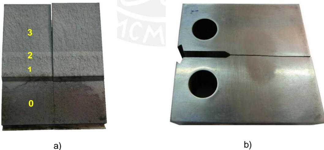
Fig. 2.16: Superficie de fractura de la probeta CT TF\_4
