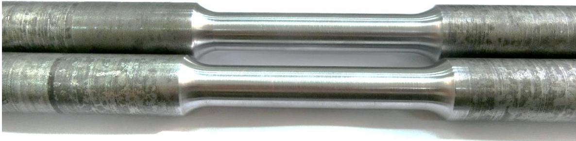
Fig. 2.2: Probetas para ensayos de tracción PT\_1 y PT\_2
