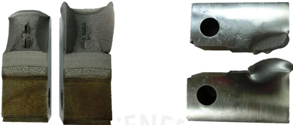
Fig. 2.15: Superficie de fractura de la probeta CT TF\_1
