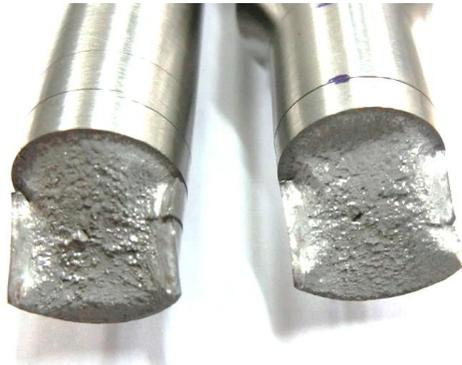
Fig. 2.4: Superficie de fractura de la probeta PT\_2
