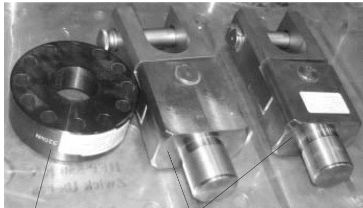
Valva roscada M48, Mordazas para CT 2",  $F_{\text{máx.}} = 100 \text{ kN}$
