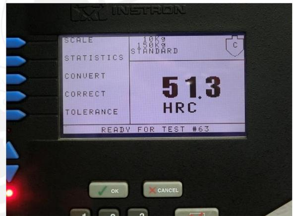
Fig. 2.7: Resultados del ensayo de dureza del acero DIN W N°: 1.8721 (templado-revenido)
