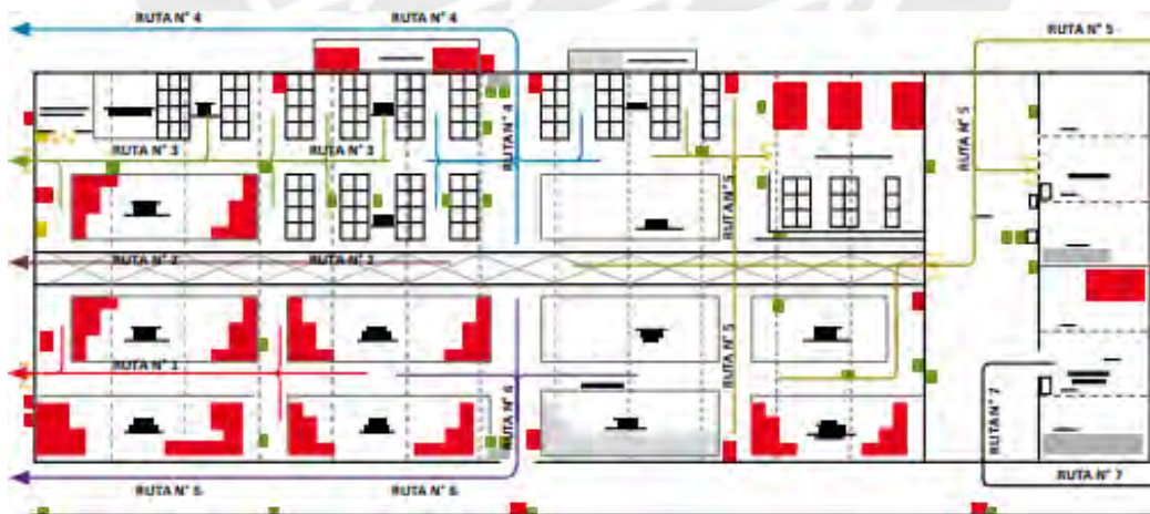
Figura 12. Ejemplo típico de un croquis de una evacuación en un centro educativo Fuente: Manual de señalización, evacuación y sistemas contra incendios (MINEDU,2015)
