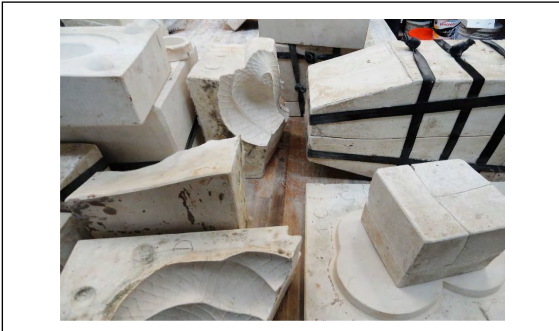
Figura 22: Moldes de yeso preparados para la reproducción de piezas cerámicas
