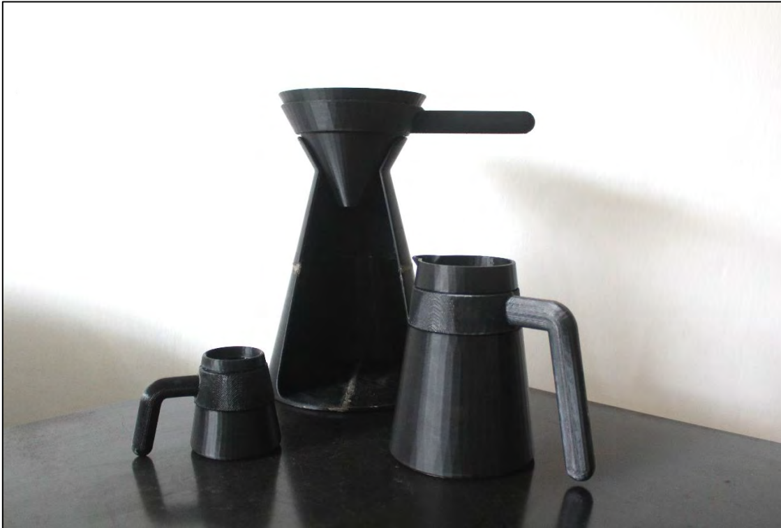
Figura 50: Prototipo de la propuesta impreso en 3D (FDM, PLA)
