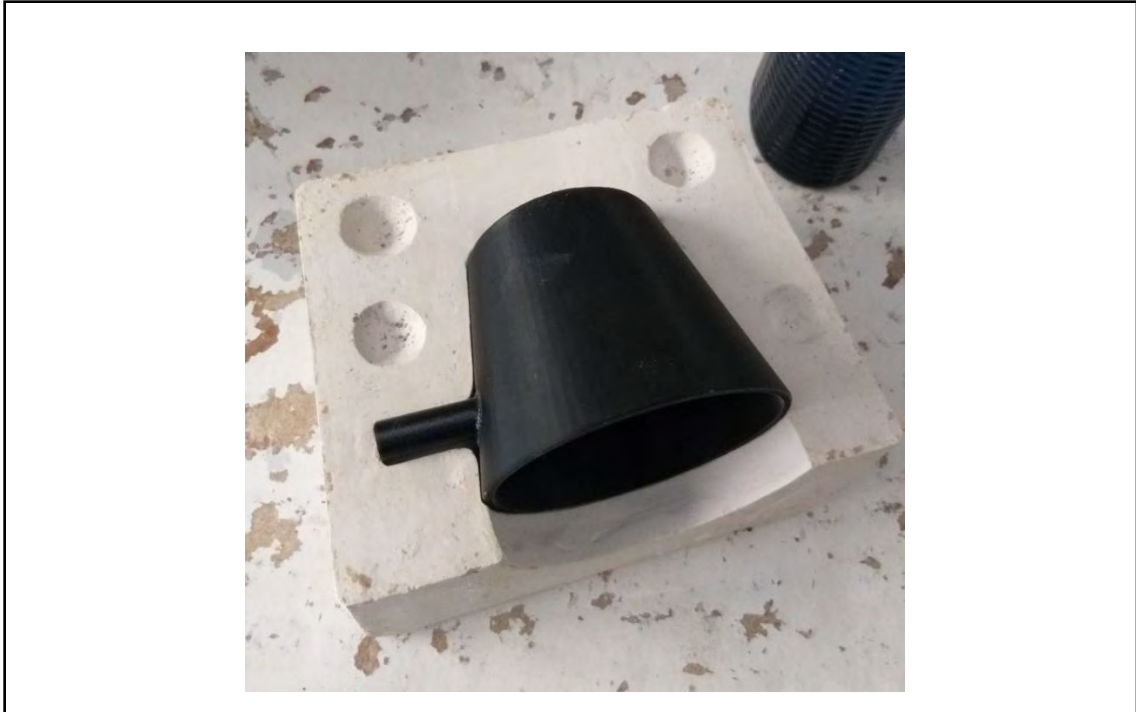
Figura 23: Molde de yeso obtenido de un matriz impresa en 3D
